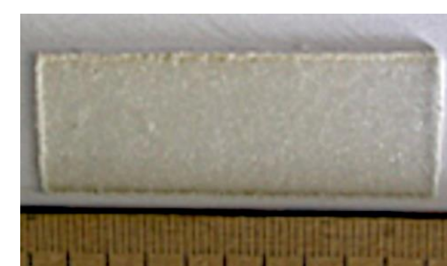
3D печать ПВДФ методом селективного лазерного спекания порошка
